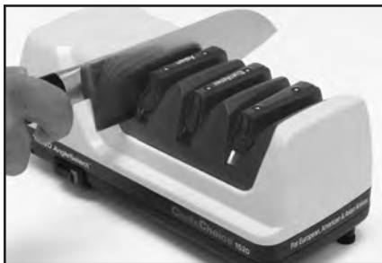
Рисунок 8. Сначала заточите современное лезвие азиатского типа в Устройстве 1.
