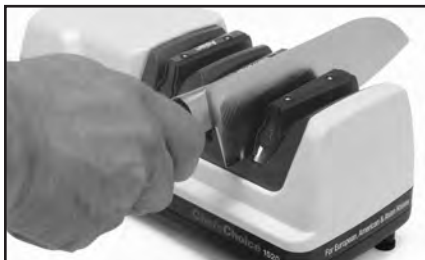
Рис. 10. Полировка современного азиатского ножа в правильном Устройстве 3.
